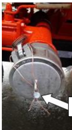
Рисунок 2 – Пломбировка трубопровода слива-налива
