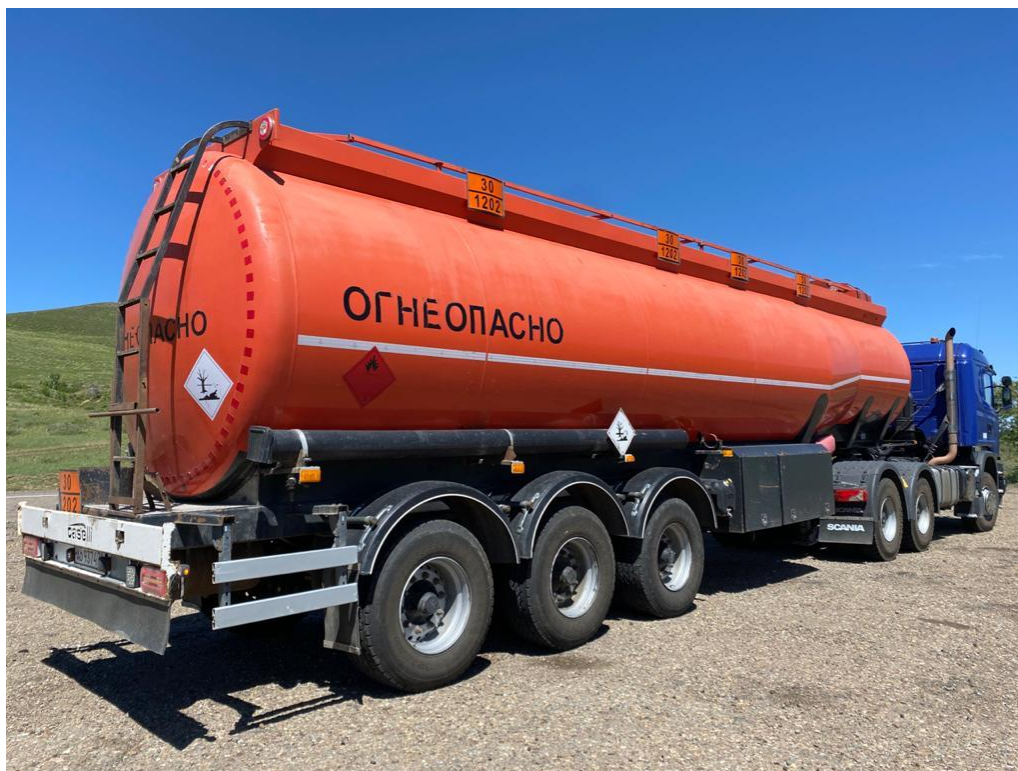
Рисунок 1 – Общий вид полуприцепа-цистерны для жидких нефтепродуктов CASELLI DMD
