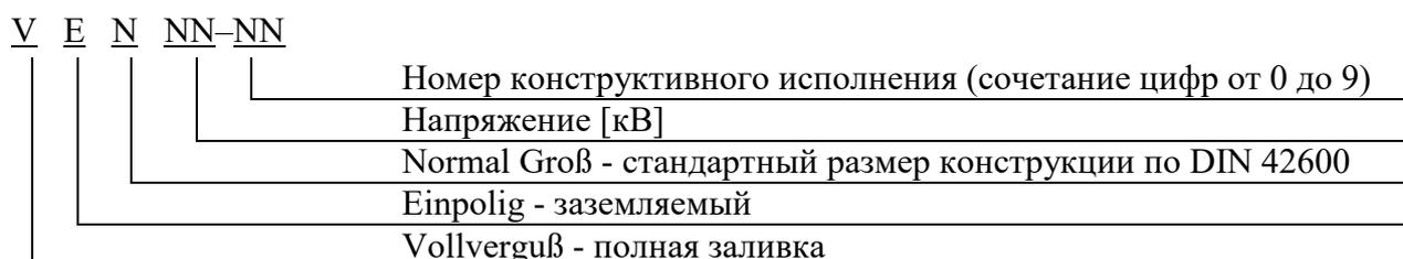
Рисунок 2 – Структура условного обозначения трансформаторов напряжения VEN
