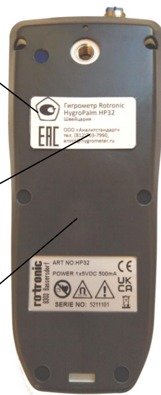
Рисунок 2 – Место нанесения знака поверки и пломбирования от несанкционированного доступа
