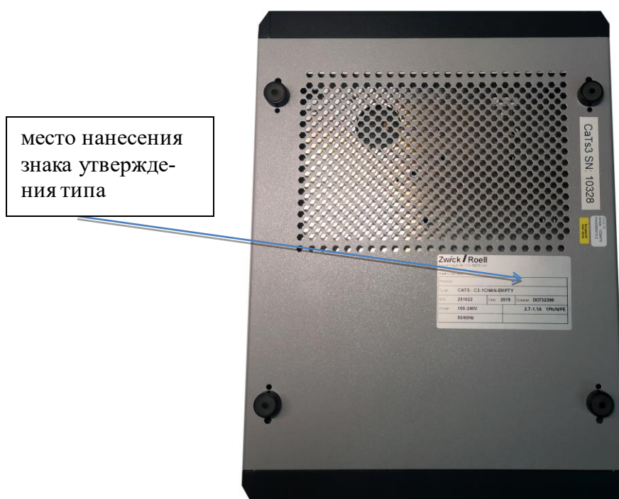
Рисунок 2 – Место размещения серийных номеров и знака утверждения типа на нижней стороне комплекса
