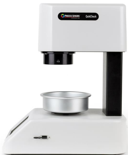
Рисунок 1 – Общий вид лабораторного ИК-анализатора MCT466-QC
