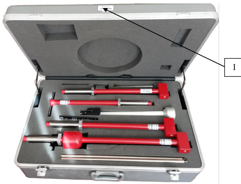
1 — место нанесения заводского номера комплекта EMCO 3121D Рисунок 1 — Общий вид комплекта EMCO 3121D в укладке (кейсе)
