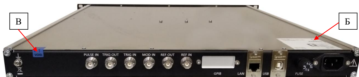
Рисунок 3 – Вид задней панели генераторов в варианте исполнения 1URM, места нанесения заводского (серийного) номера (Б) и пломбировки от несанкционированного доступа (В)
