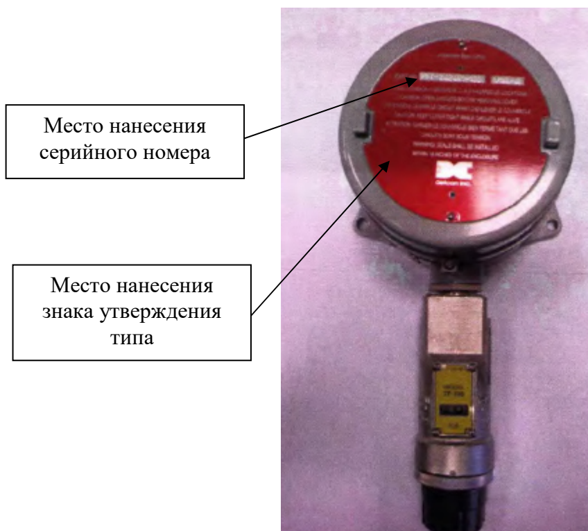
Рисунок 1 - Общий вид газоанализаторов с указанием места нанесения знака утверждения типа, места нанесения серийного номера
