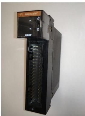
Рисунок 2 – Измерительный модуль 1756-IF8N
