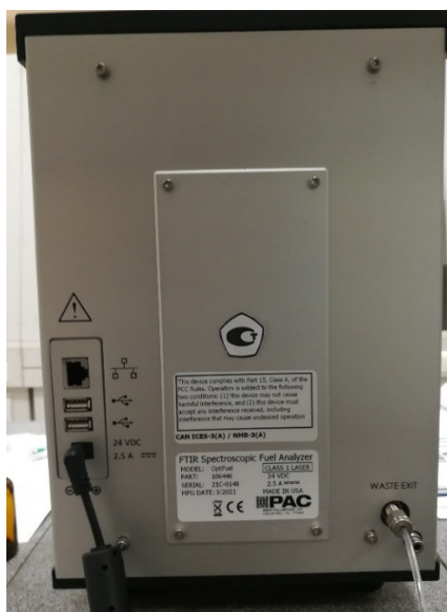
Рисунок 2 – Вид задней стенки анализатора с шильдиком и знаком утверждения типа
