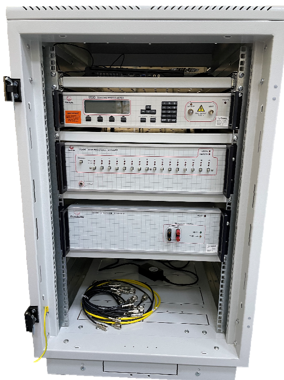
Рисунок 1 – Общий вид лицевой панели установки 6535 ноутбук MSI (первая выдвижная полка), тераомметр 6530-XPR (вторая полка), сканер 6564 (третья полка) и набор опорных термостатированных мер 6636-6 (четвертая полка)
