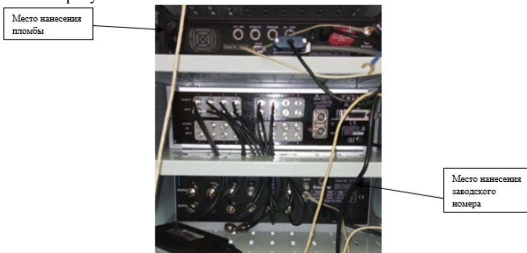
Рисунок 2 – Общий вид задних панелей тераомметра 6530-XPR (верхний прибор), сканера 6564 (средний прибор) набор опорных термостатированных мер (нижний прибор) с указанием места пломбировки и заводского номера
