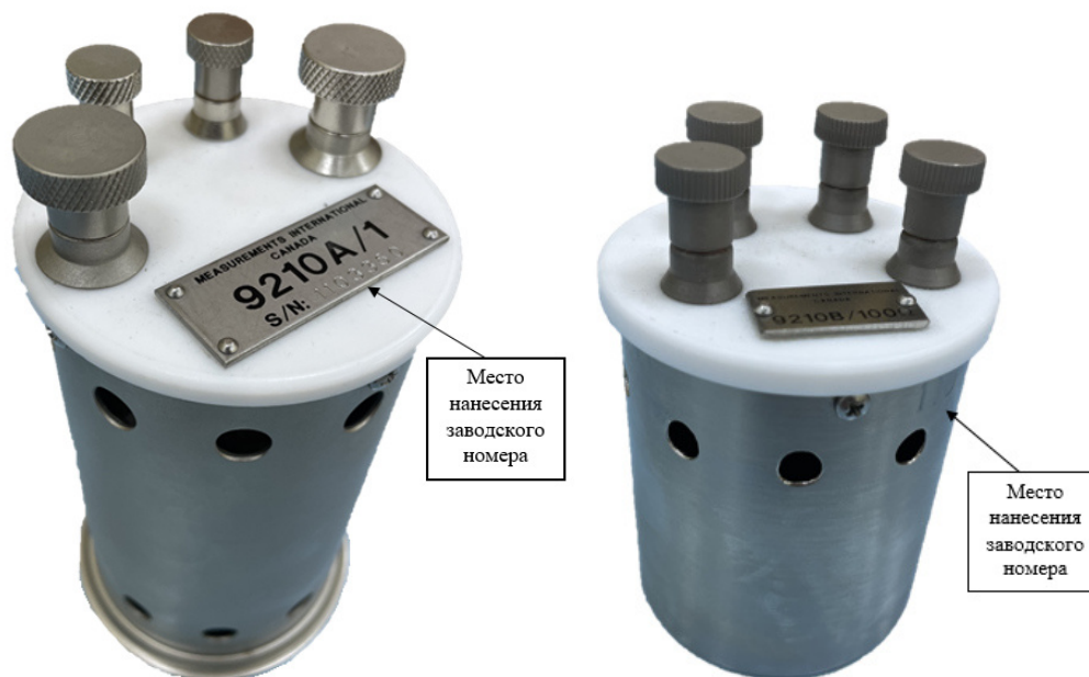
Рисунок 1 - Общий вид мер МІ 9210 с указанием мест нанесения заводского номера. Модификация МІ 9210А – слева, модификация МІ 9210В - справа
