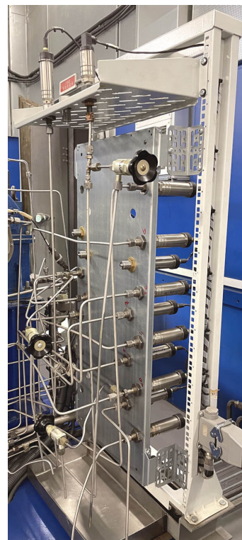
Рисунок 3 - Стойка датчиков давления
