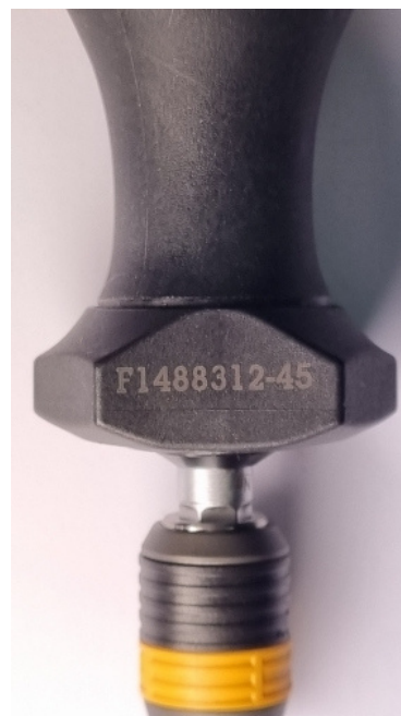
Рисунок 14 - Пример нанесения информации об исполнении, артикуле (а), серийном номере (б) отвертки моментной предельной WERA модификации 7400 Kraftform ESD, 7441 ESD
