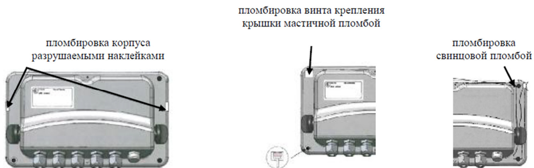
а) Схема пломбировки индикаторов i 35, i 40
