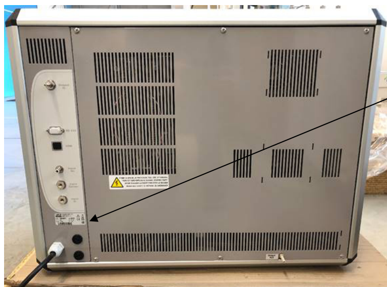
Рисунок 4 – Место нанесения серийного номера на анализаторы азота и углерода
