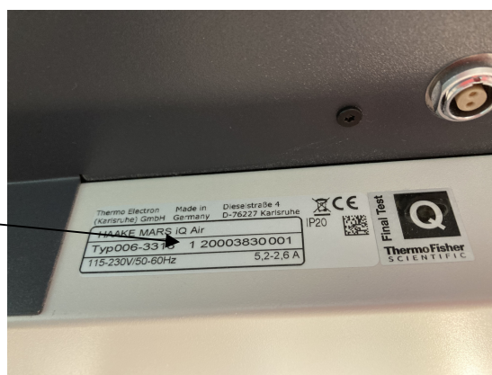
Рисунок 2 – Место нанесения заводского номера на реометр ротационный НААКЕ Mars iQ Air
