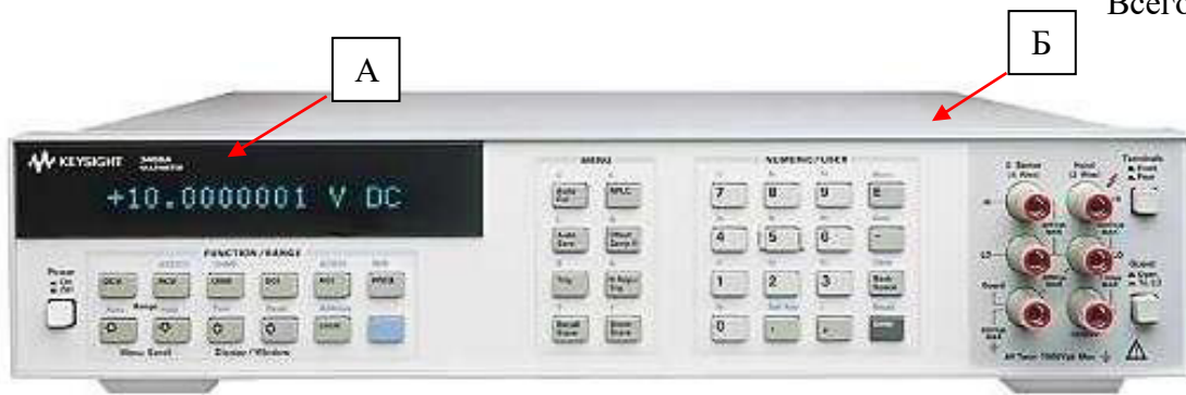
Рисунок 1 – Общий вид мультиметров 3458А, места нанесения знака утверждения типа (А) и знака поверки (Б)
