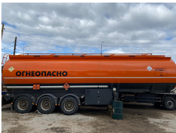
Рисунок 2 – Полуприцеп-цистерна для жидких нефтепродуктов ALI RIZA USTA, заводской номер NP9A3TYCTEH042008. Вид с бока.
