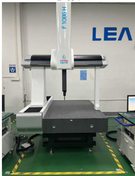
Рисунок 3 - Общий вид машин координатных измерительных IntraLEAD модификаций F
