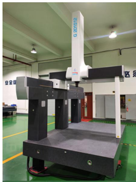
Рисунок 4 - Общий вид машин координатных измерительных IntraLEAD модификаций G
