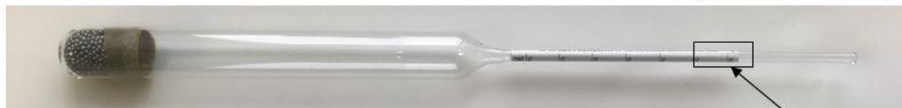
Рисунок 3 – Общий вид ареометров для нефти стеклянных АН
