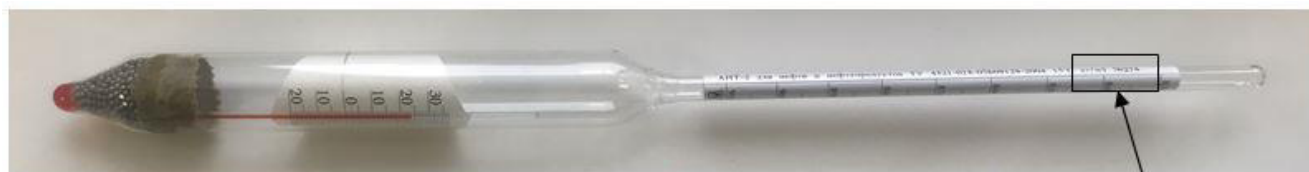
Рисунок 2 – Общий вид ареометров для нефти стеклянных АНТ-2
