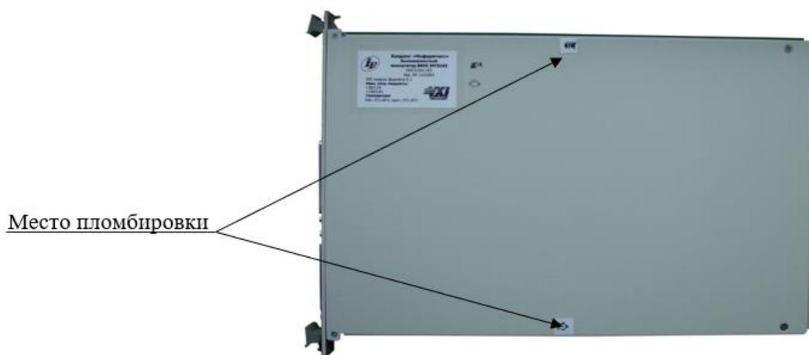
Рисунок 2 – Пломбировка функционального модуля
