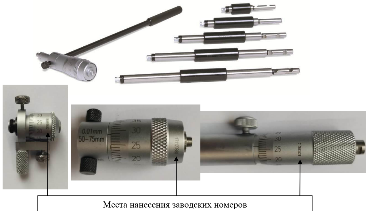
Рисунок 1 – Общий вид нутромеров модели 3221 с указанием мест нанесения заводских номеров
