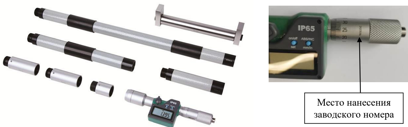
Рисунок 6 – Общий вид нутромеров модели 3521 с указанием места нанесения заводского номера
