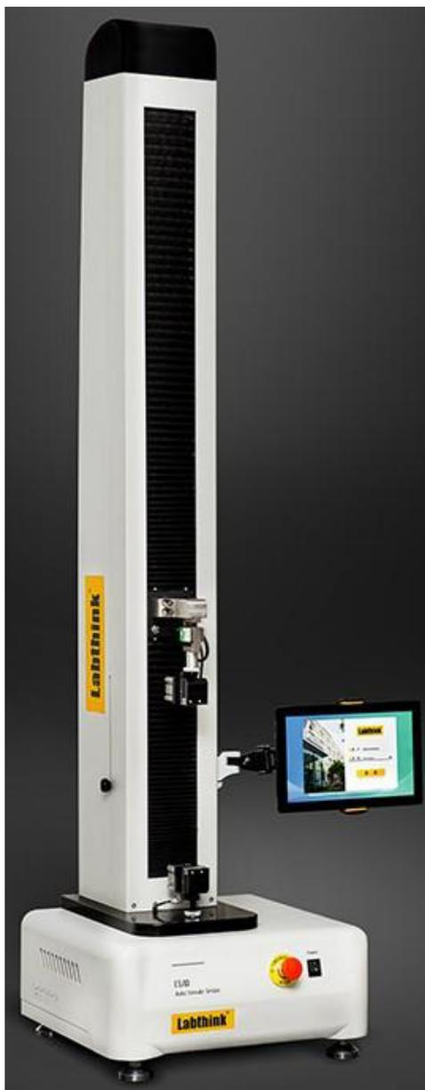
Рисунок 1 – Общий вид машин для измерения характеристик материалов С610Н
