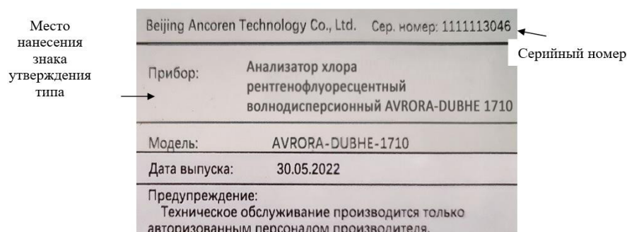
Рисунок 2 – Место нанесения серийного номера и знака утверждения типа анализатора хлора рентгенофлуоресцентного волнодисперсионного AVRORA-DUBHE 1710
