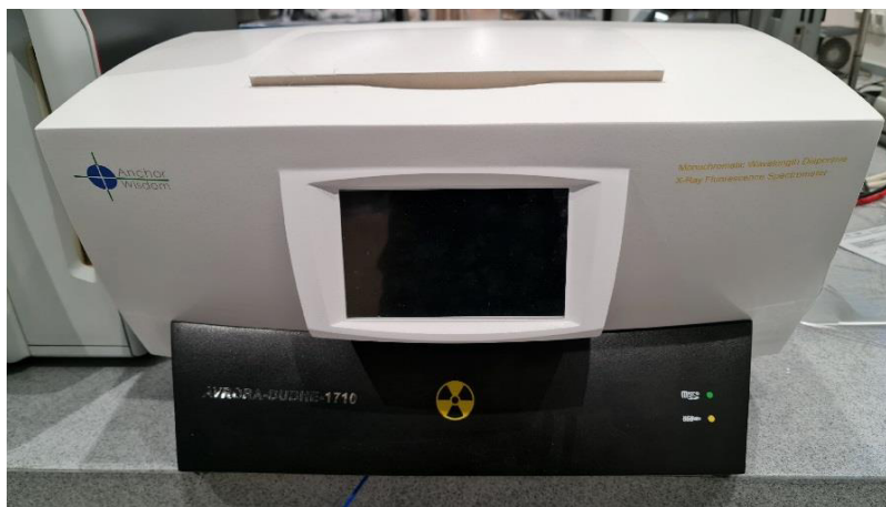
Рисунок 1 – Общий вид анализатора хлора рентгенофлуоресцентного волнодисперсионного AVRORA-DUBHE 1710
