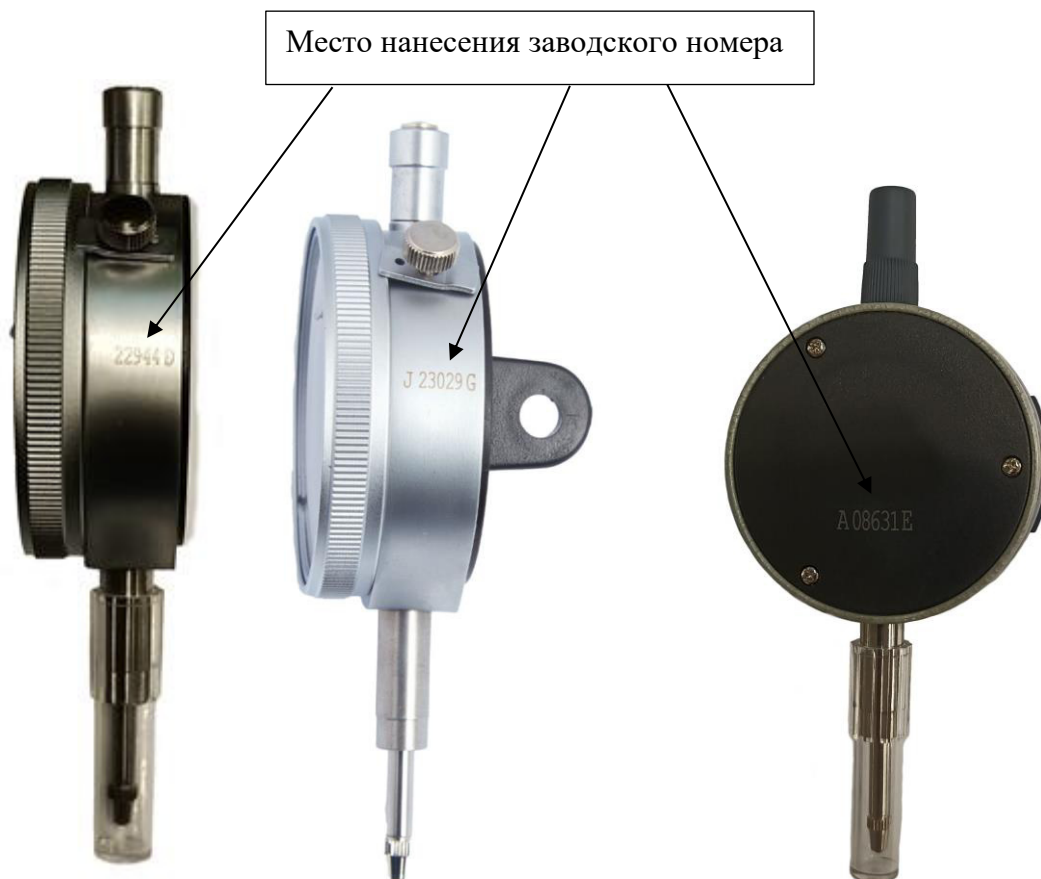
Рисунок 5 – Места нанесения заводского номера
