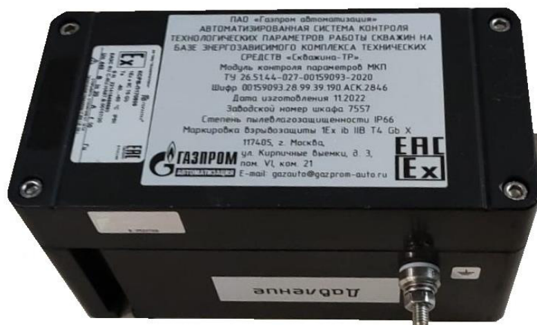
Рисунок 1 – Общий вид модуля контроля параметров Скважина-ТР, место нанесения этикетки
