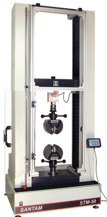
Рисунок 4 – Общий вид машин модификации STM-50
