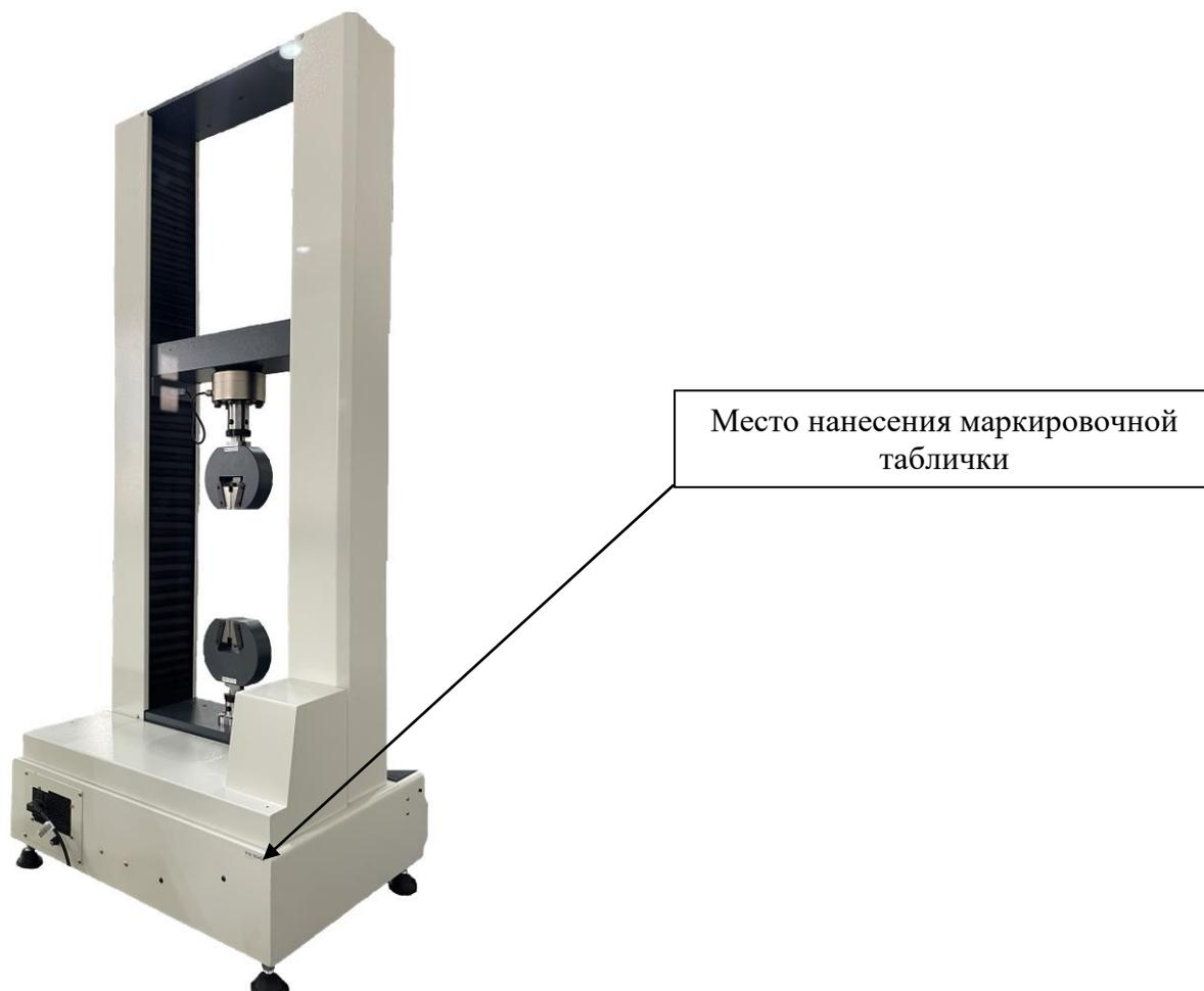
Рисунок 14 - Место нанесения маркировочной таблички на примере машины STM-50
