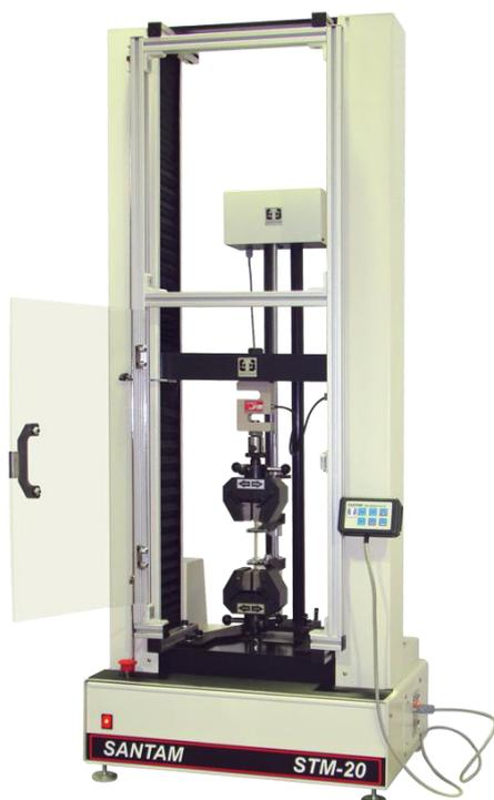
Рисунок 3 – Общий вид машин модификации STM-20
