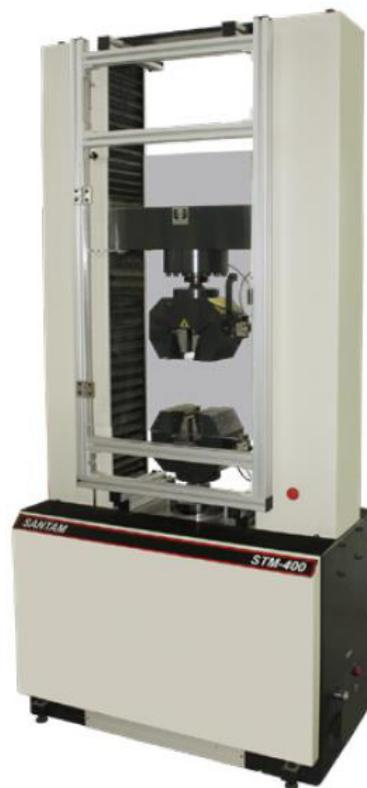
Рисунок 8 – Общий вид машин модификации STM-400
