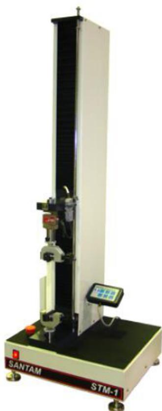
Рисунок 1 – Общий вид машин модификации STM-1
