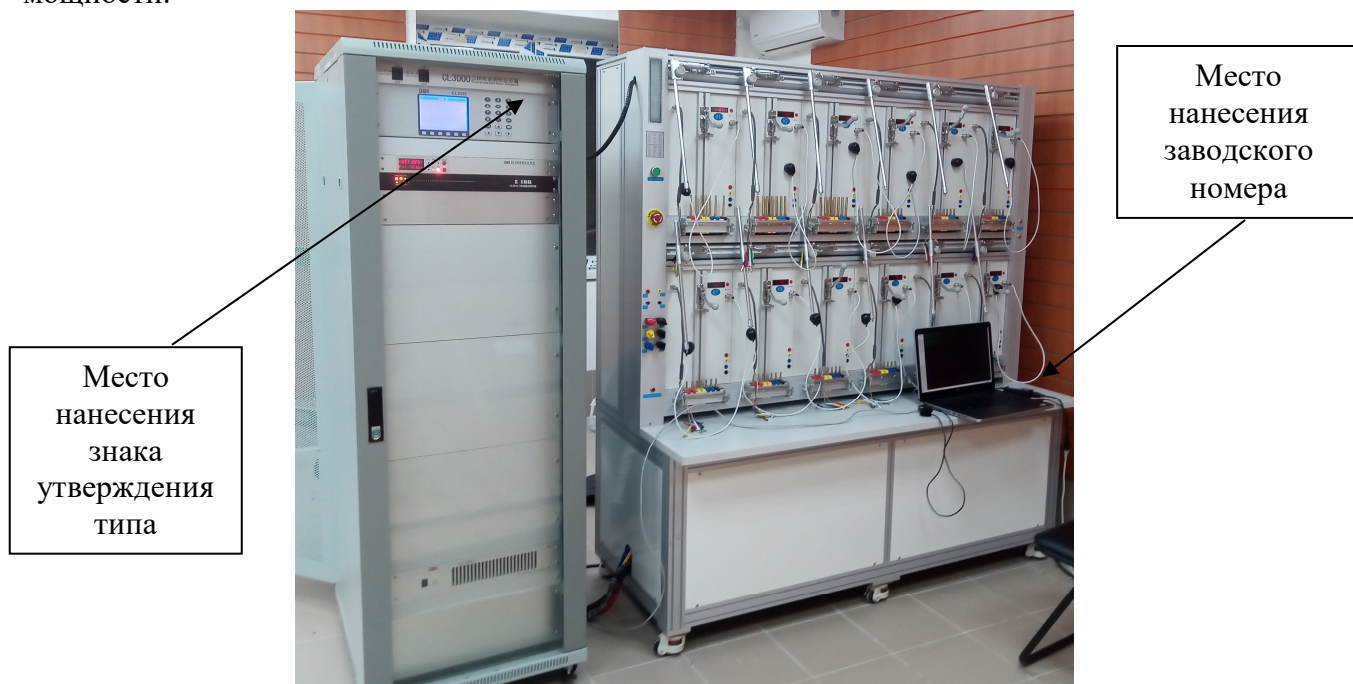
Рисунок 1 – Общий вид установки с указанием места нанесения знака утверждения типа и заводского номера
