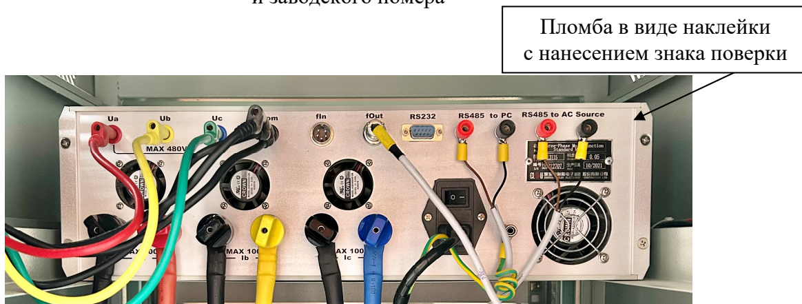
Рисунок 2 – Задняя панель корпуса эталонного счётчика с указанием места ограничения доступа к местам настройки (регулировки)
