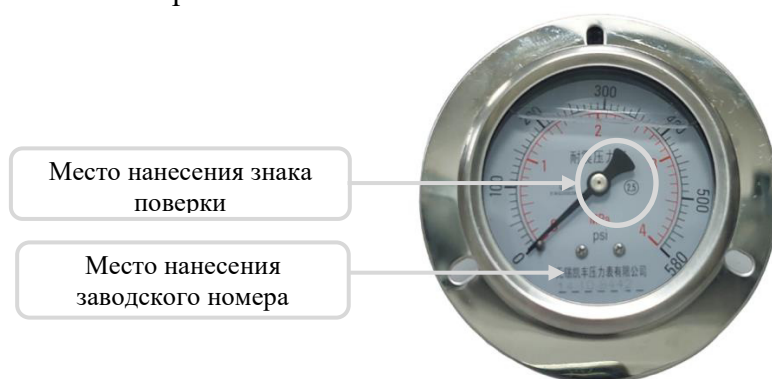
Рисунок 1– Общий вид манометров с местами нанесения знака поверки и заводского номера
