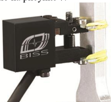
Рисунок 1 - Общий вид измерителей линейных перемещений AC-07 модификаций AC-07-1005, AC-07-1010, AC-07-1015, AC-07-1020, AC-07-1025, AC-07-1030, AC-07-1035, AC-07-1040, AC-07-1045, AC-07-1050, AC-07-1055, AC-07-1060, AC-07-1065, AC-07-1070, AC-07-1075, AC-07-1080, AC-07-1085, AC-07-1090, AC-07-1095
