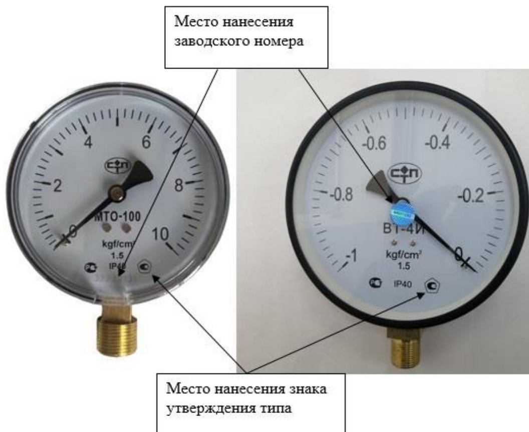
Рисунок 1– Общий вид манометров с местами нанесения заводского номера и знака утверждения типа
