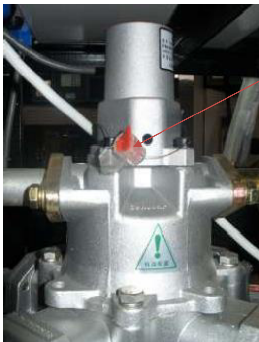
Рисунок 3 - Схема пломбировки датчика импульсов
