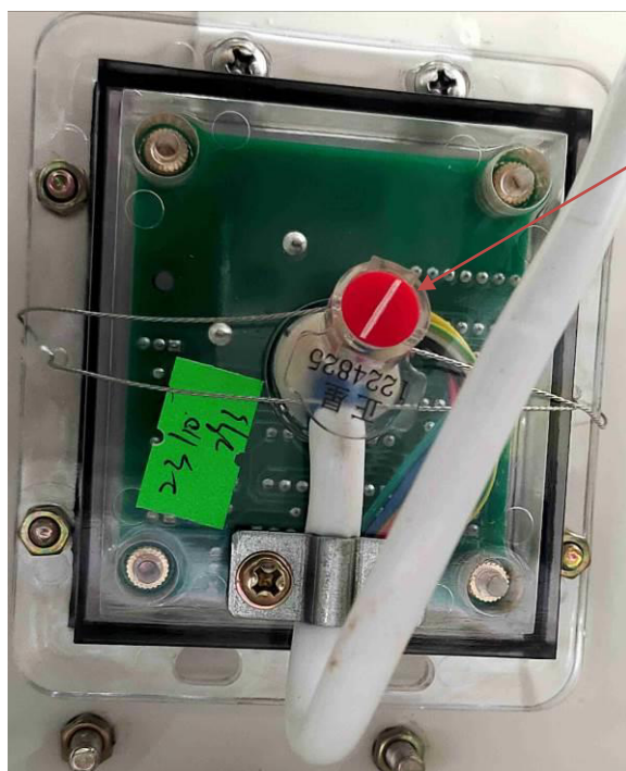
Рисунок 4 - Схема пломбировки электромеханического суммарного счетчика (при наличии)
