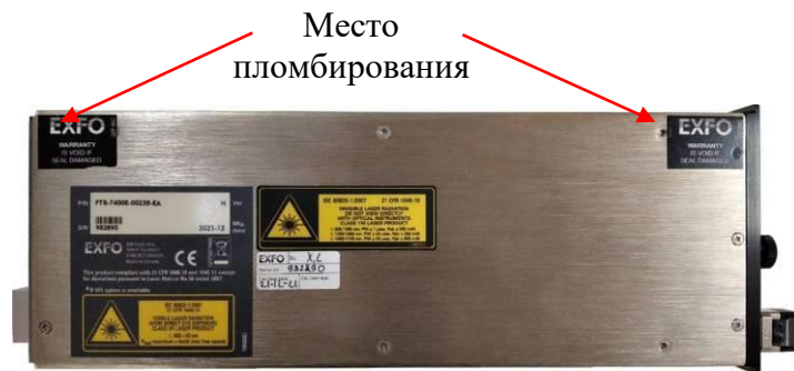
Рисунок 2 – пример схемы пломбирования сменного модуля
