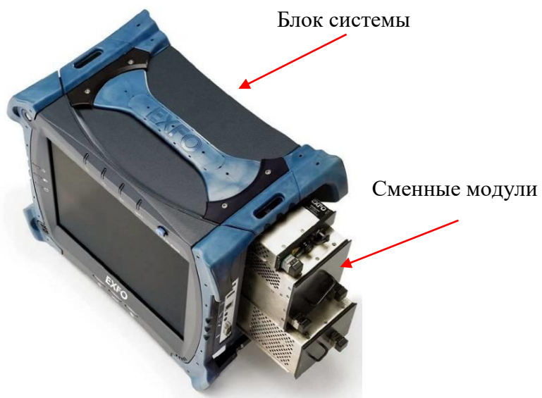
Рисунок 1 – Установка сменных модулей в блок системы
