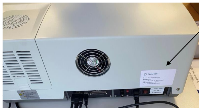
Рисунок 2 – Место нанесения маркировочной таблички с серийным номером и знаком утверждения типа
