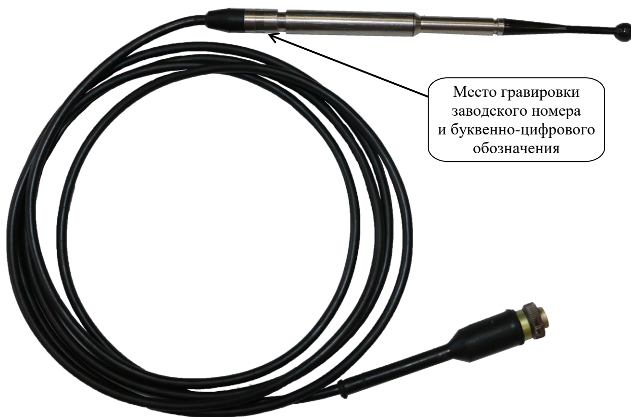
Рисунок 1 - Общий вид гидрофона
