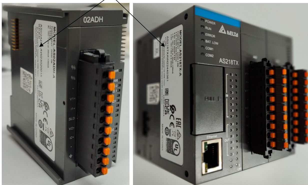
Рисунок 1 – Общий вид модулей AS (слева - модули аналогового ввода-вывода; справа - модули ЦПУ)
