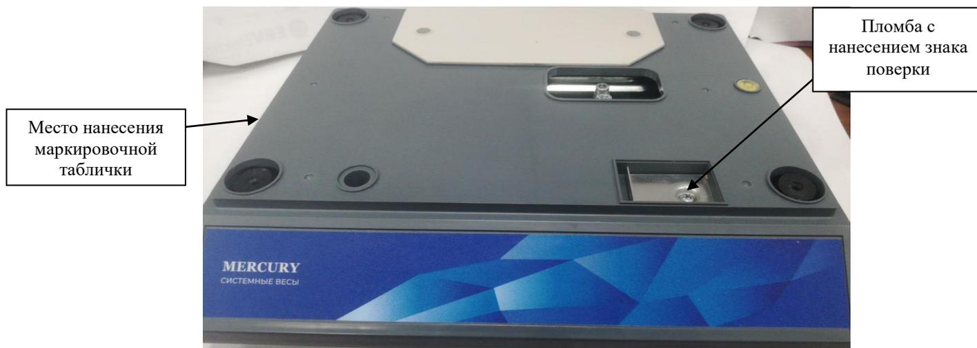
Рисунок 3 – Схема пломбирования весов
