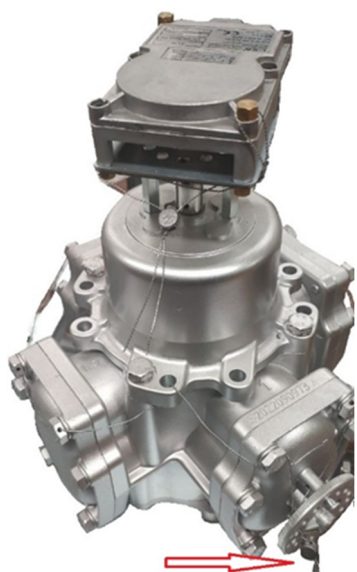
Рисунок 3 - Пломбировка измерителя объема JSJ4 по периметру верхней и боковых крышек
