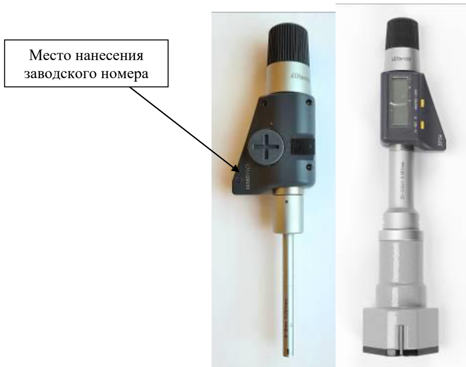
Рисунок 6 - Общий вид нутромеров модели НМТЦ с указанием места нанесения заводского номера
