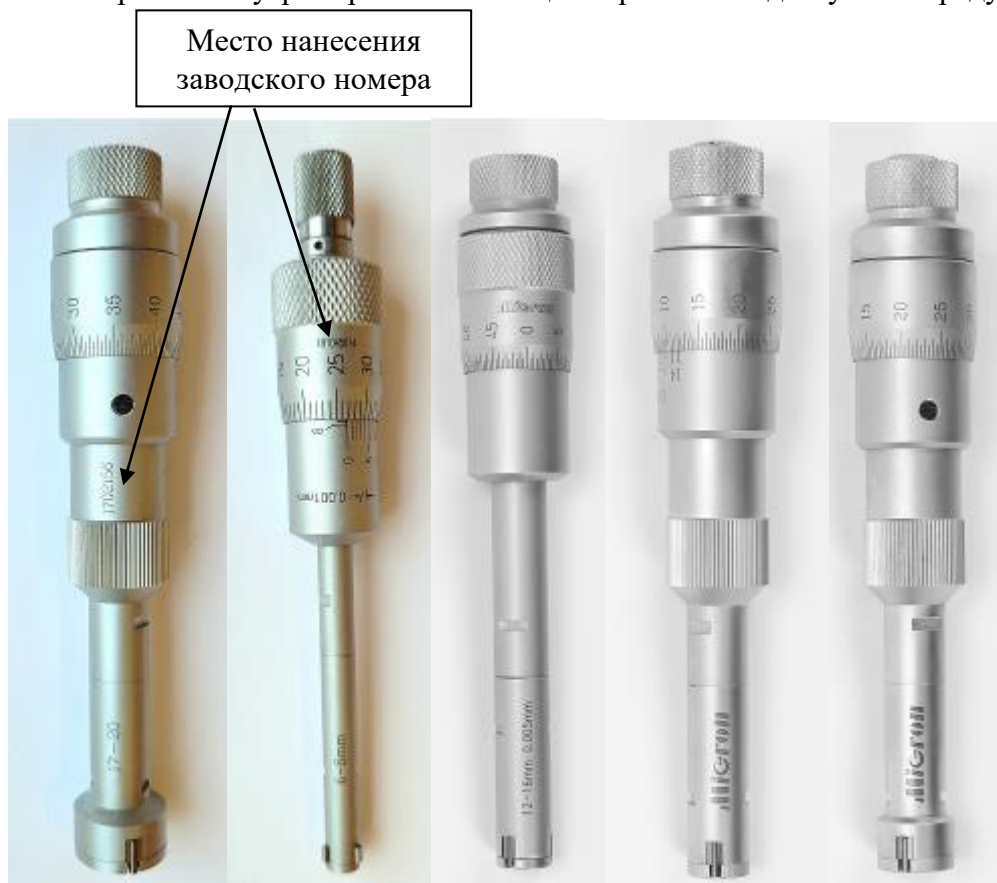
Рисунок 1 - Общий вид нутромеров модели НМТ с указанием места нанесения заводского номера
