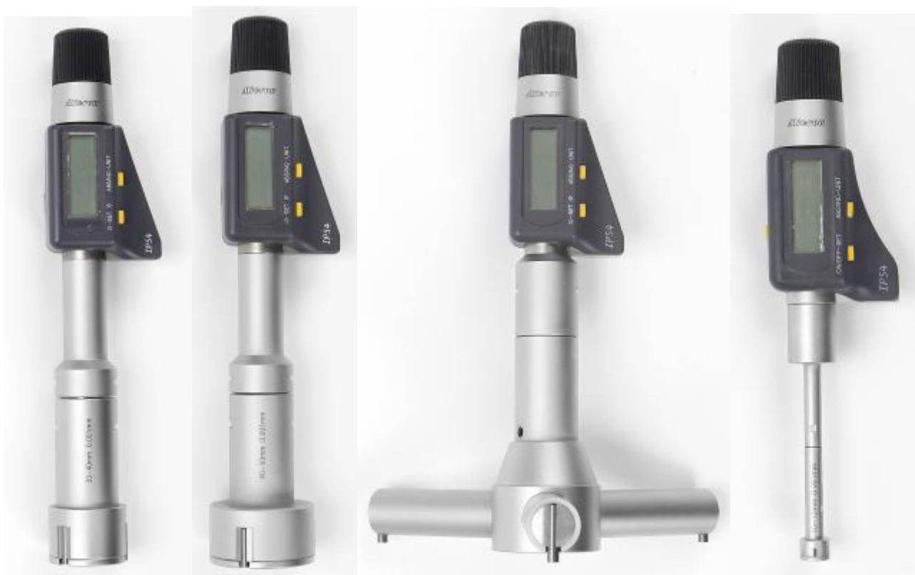
Рисунок 5 - Общий вид нутромеров модели НМТЦ
