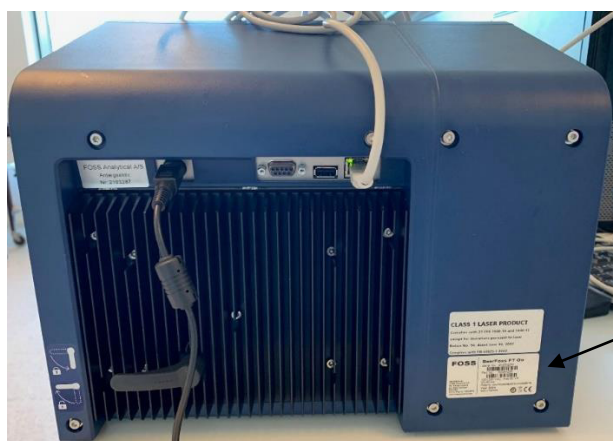
Рисунок 2 – Место нанесения серийного номера на анализаторы пива, сидра и пивоваренной продукции BeerFoss FT Go
