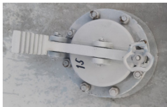
Рисунок 15 – Общий вид резервуара РВС-5000 (заводской номер 15) с замерным люком
