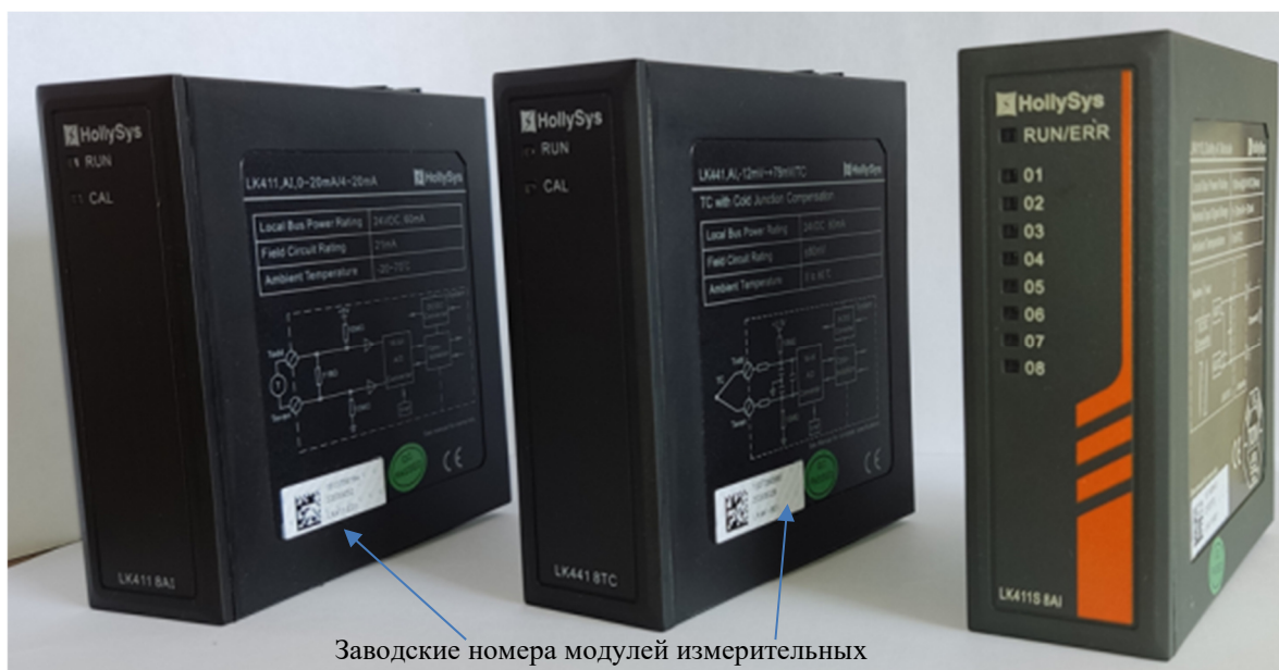
а) б) в) Рисунок 2 – Общий вид модулей измерительных систем управления LK(S)- а) и б) систем управления LK, в)- систем управления LKS
