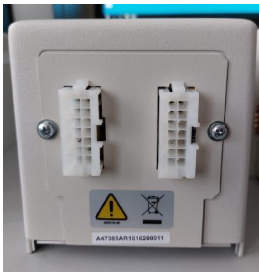
Рисунок 2 – Место нанесения заводского номера детектора
