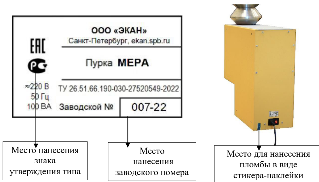
Рисунок 2 – Общий вид маркировочной этикетки с указанием места нанесения знака утверждения типа, заводского номера и места пломбировки
