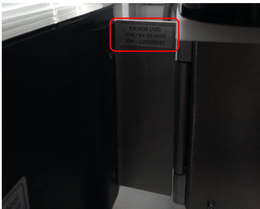
Рисунок 3 – Место нанесения серийного номера блока хроматографа EX1800 на внутренней стороне дверцы лицевой панели блока
