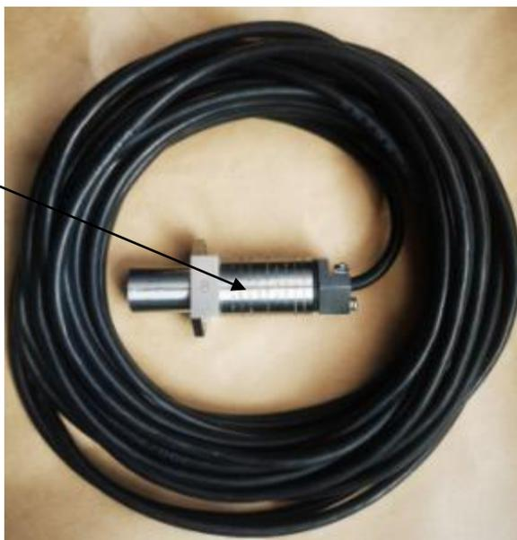
Рисунок 3 - Общий вид датчиков частоты вращения BCG-P/20A
