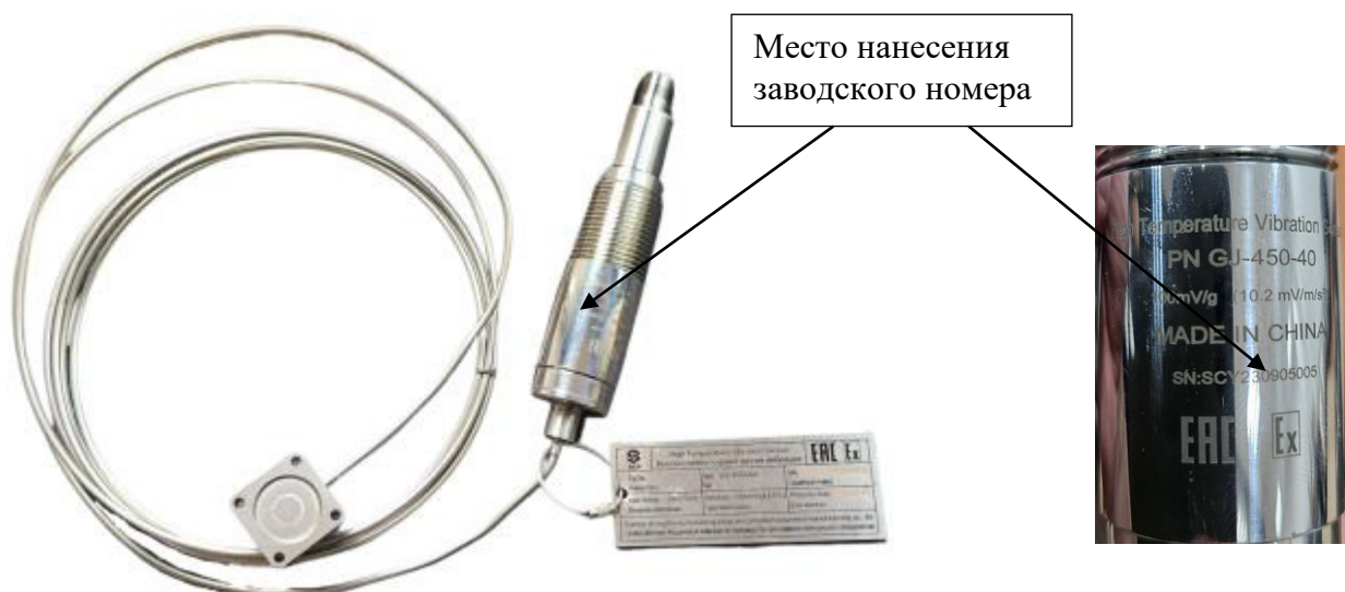
Рисунок 1 - Общий вид датчиков вибрации GJ-450-40
