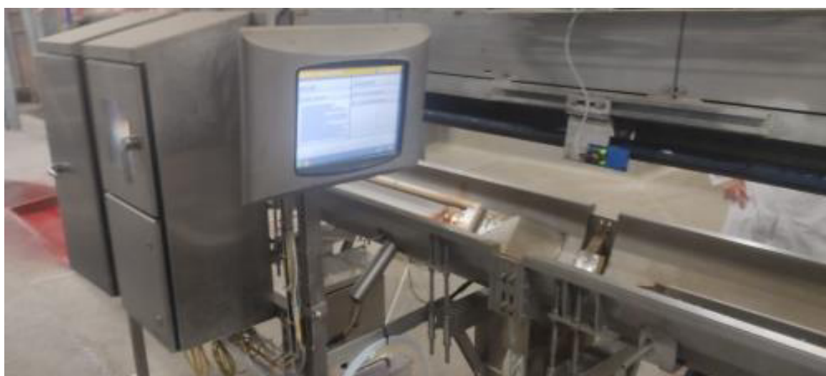
Рисунок 2 – Общий вид прибора для измерения толщины шпика AutoFom III AF330-D.
