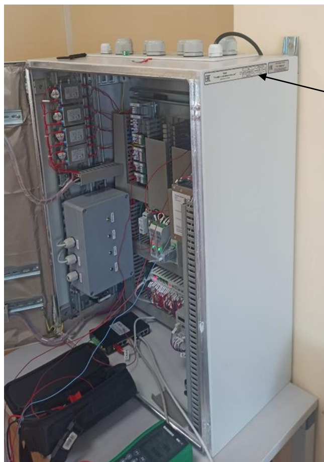
Рисунок 2 – Место нанесения заводского номера на комплекс
